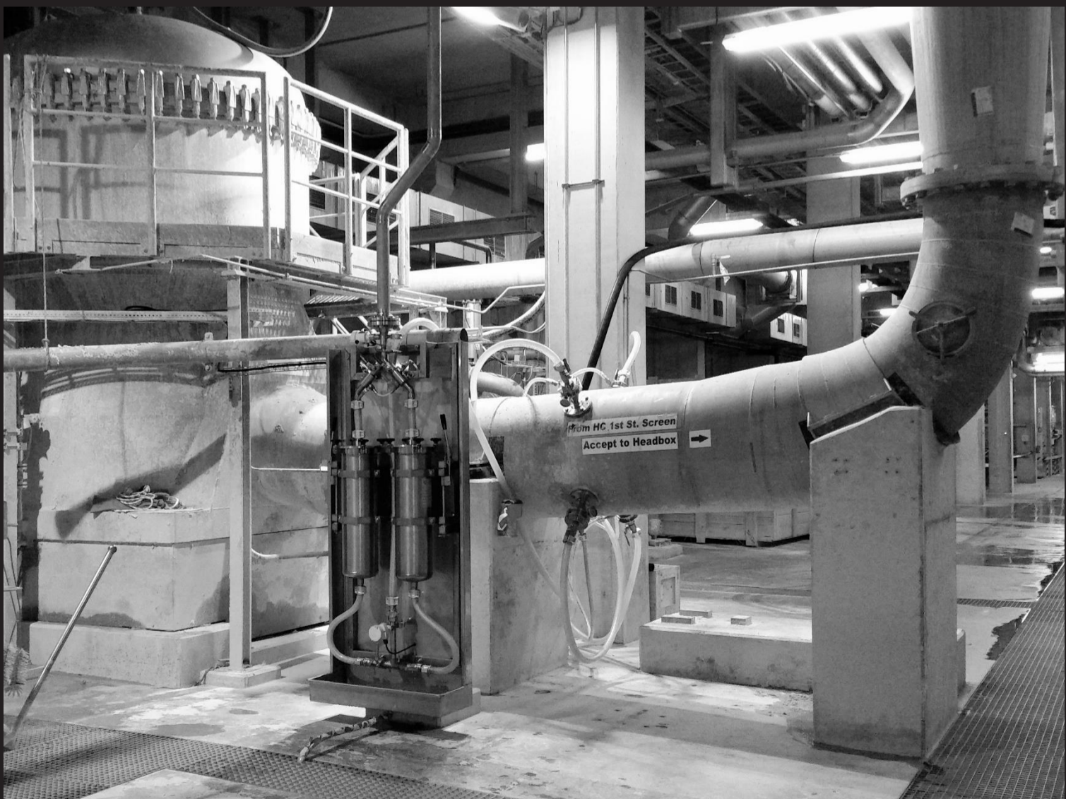
Abbildung 1: 4-Kopf-ecowirl-Anlage mit econovation-Filtersystem nach Sichter in der Papierfabrik Palm in Kingslynn
